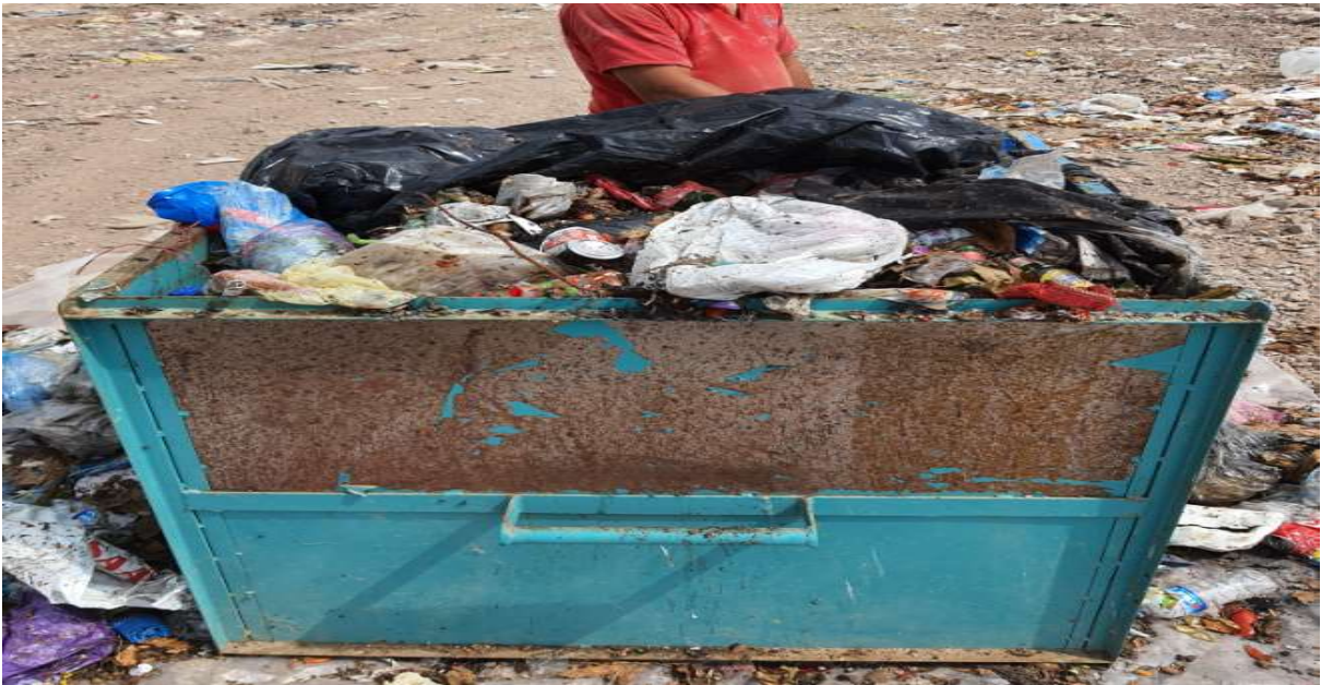
Şekil 2 Karışık Kentsel Katı Atıkların Karakterizasyonunda Kullanılan 1x1x1 m Metal Hazne
